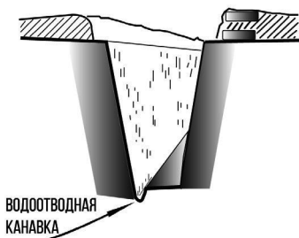
Рис. 2. Водоотводная канавка на дне траншеи
