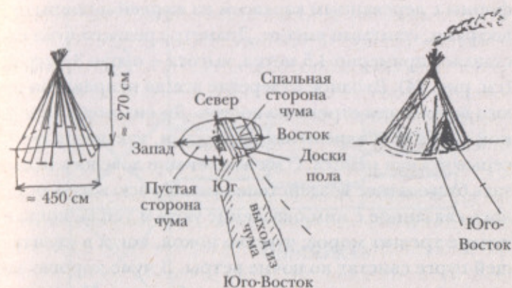
Рис. 84. Устройство ненецкого чума
