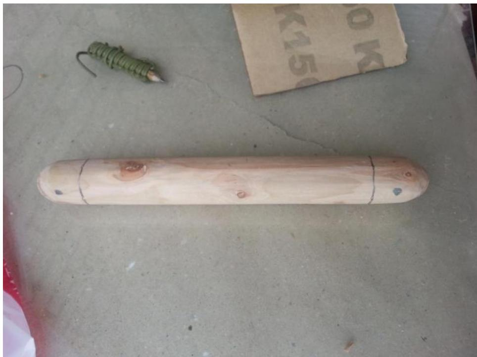
При помощи круглой стамесочки, струбцины и имени такой-то матери, ручка была выточена и зашкурена сначала грубой шкуркой, потом нулевкой. Одновременно была зашкурена заготовка для колотушки, все сучки и острые части были спилены напильничком.
