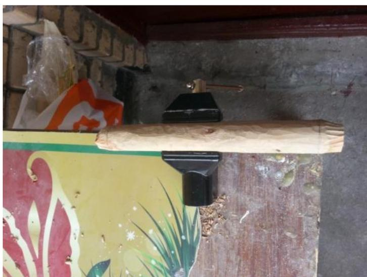
Закруглив концы я зажимая в струбцину заготовку хорошенько фиганул ее брусом с средней шкуркой, напильником закруглил концы и по ним тоже прошел шкуркой.
