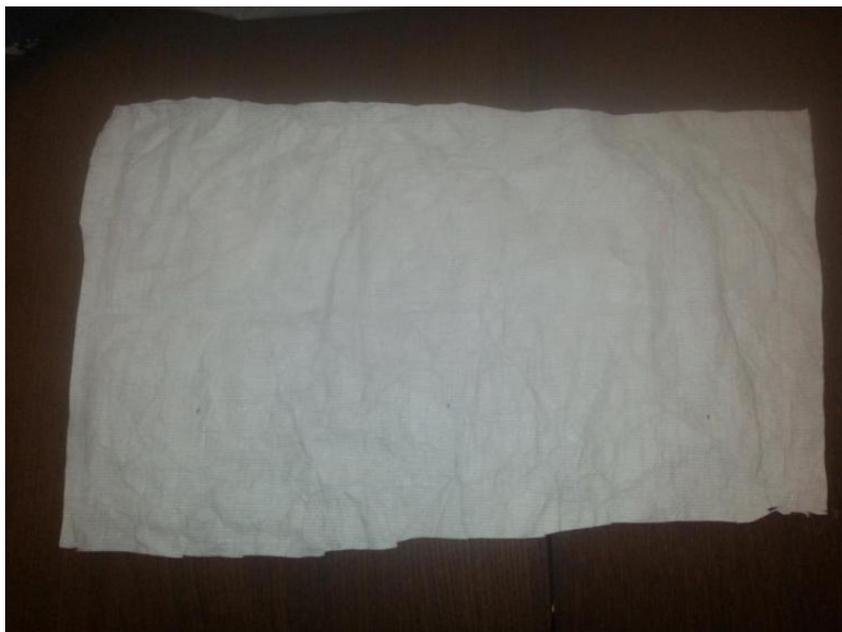
Тайвек разложен шершавой стороной вверх. Крышкой примеряемся и на то место что приходится на центр крышки наносим каплю силикона по форме и размеру как горошина. Не больше!
