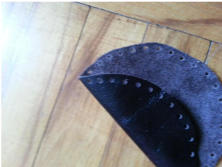
Шнурком из сыромяти собрал все это в мешочек. Одел на колотушку и затянул 2мя простыми узлами, отрезав лишнее.
