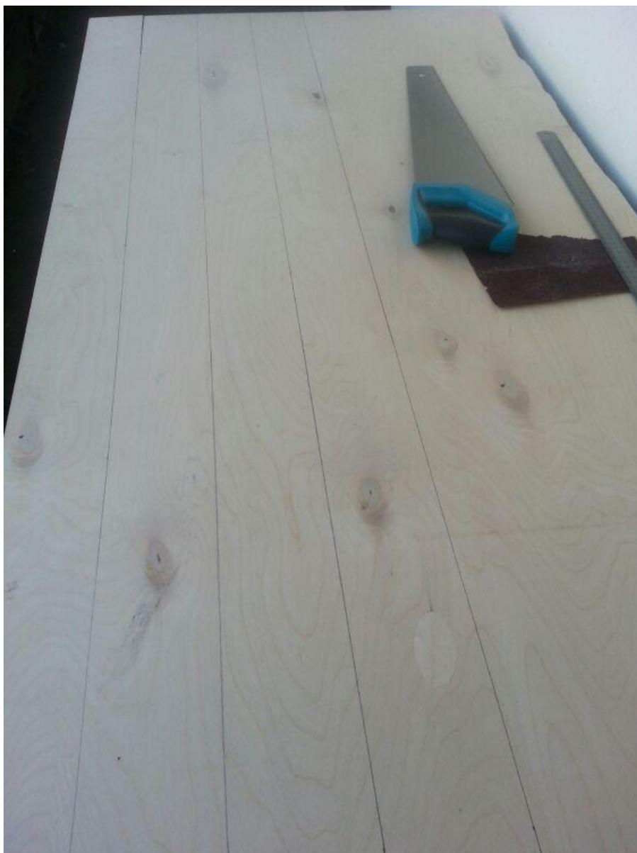
Пилой с мелкими зубьями аккуратно отпилить полосы. Старайтесь по-минимуму расщеплять фанеру. Можно даже с обратной стороны малярный бумажный скотч. При пропиливании следите, чтоб отпиленная часть не провисала. Это создает напряжение в древесине. Я подкладывал железную линейку.
