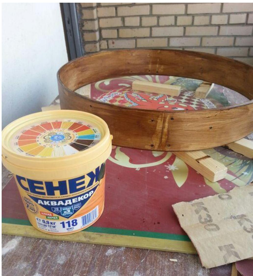
Ждем час и наносим еще слой. Я нанес 4 слоя, т. к. хотел глубокого темного оттенка, чтоб гармонировал с естественными темными пятнами на коже, которую купил.
