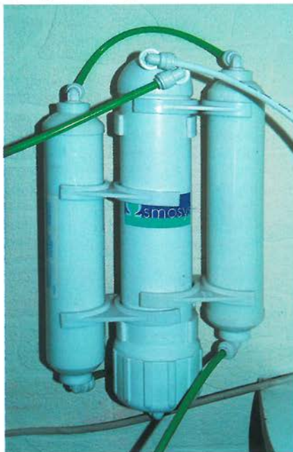
Этот фильтр обратного осмоса превращает воду с высоким числом ppm или высокой электропроводностью в воду, где ppm меньше 10.
