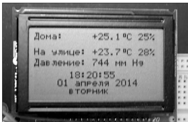
Рис. 22.6. Отображение результатов работы метеостанции на ЖК-дисплее
