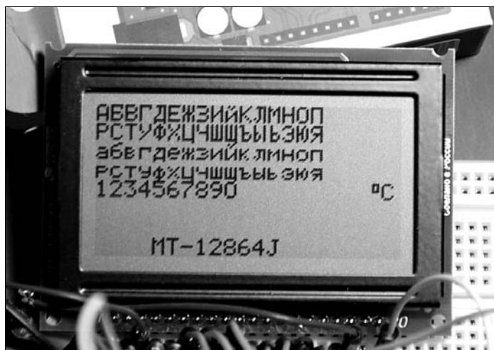
Рис. 21.5. Результат выполнения тестовой программы для дисплея MT-12864J
