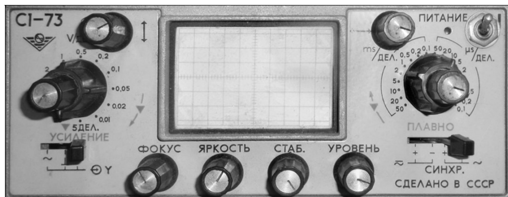
Рис. 2.4. Панель малогабаритного аналогового осциллографа С1-73
