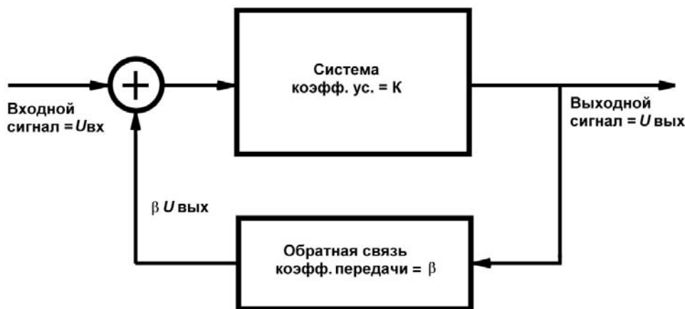
Рис. 12.2. Обобщенная схема системы с отрицательной обратной связью
